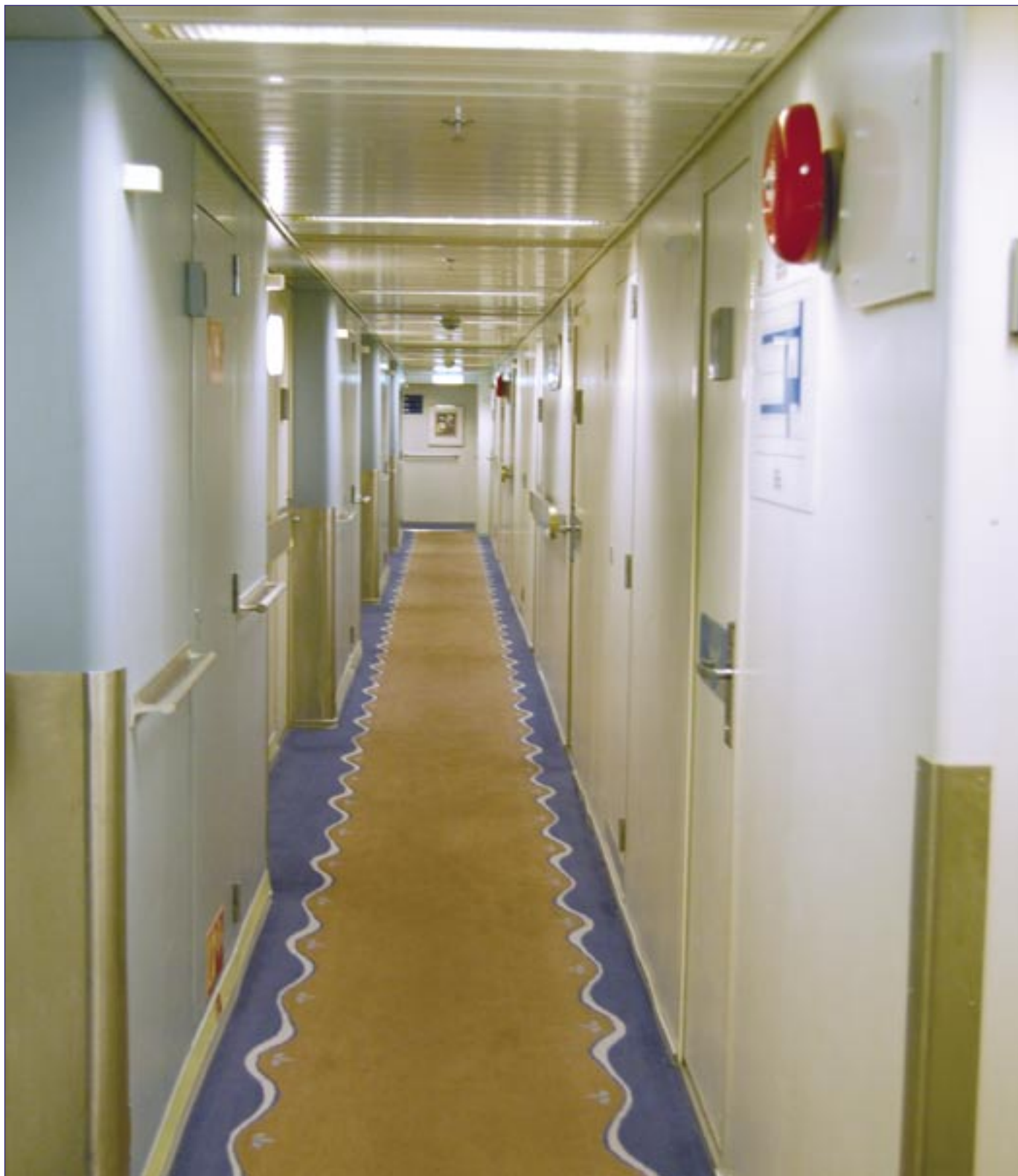
Figur 6 Normalkrav: Den mest brukte lystekniske parameteren for å måle belysning er belysningsstyrken. Den har enheten lux. I en korridor er vanlig belysningsstyrke 100 lux.
