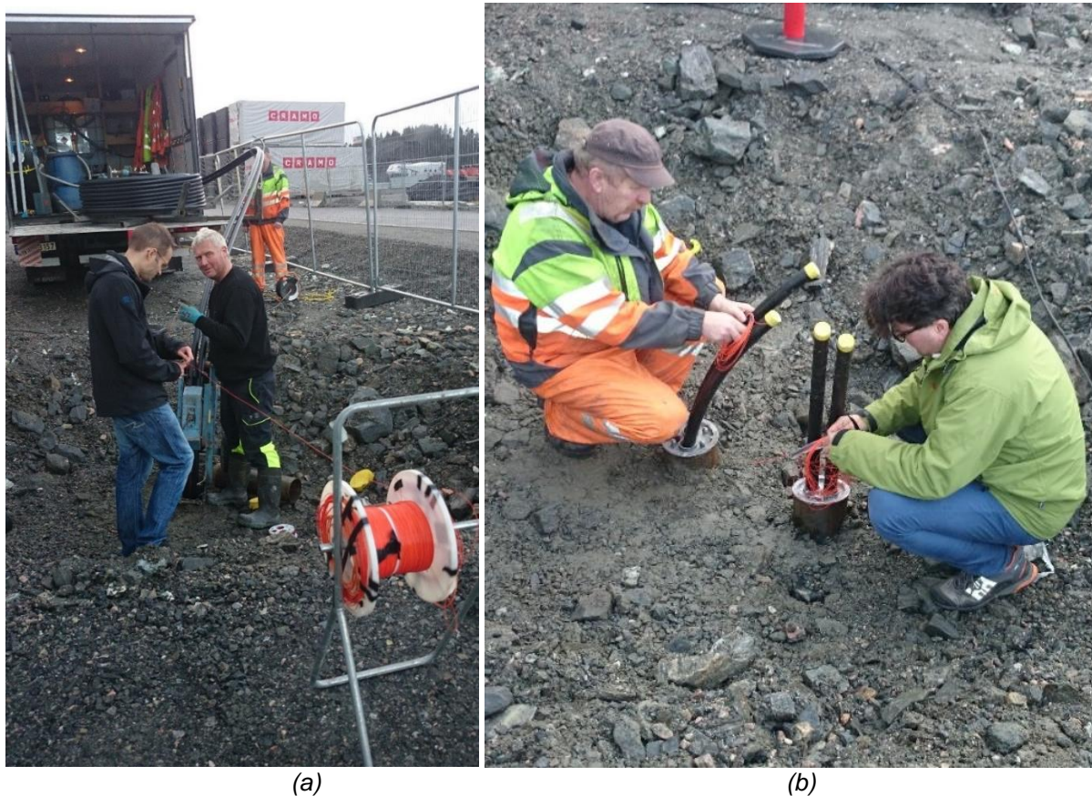
Figur 2. Bilder fra datainnsamlingen på Meland den 18. november. (a) Festing av fiber på kollektorslange for østre borehull. (b) Innfesting av fiber etter at slange er ført ned i borehull for henholdsvis østre og vestre borehull.
