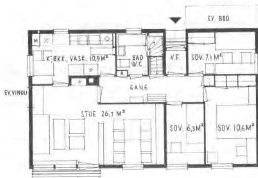
PLAN 122 C+ 4 ROM + KJØKKEN OG BAD BRUTTO-AREAL: 12,04 • 7,34 = 89,8 M² + 1,1 M² = 88,7 M² LEIEAREAL: 81 M²
