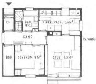
PLAN 122 A ÷ 2 ROM - KJØKKEN OG BAD BRUTTO-AREAL: 8,54 \cdot 7,34 = 62,7 \text{ M}^2 = 1,1 \text{ M}^2 \cdot 61,6 \text{ M}^2 LEIE-AREAL 51,5 \text{ M}^2
